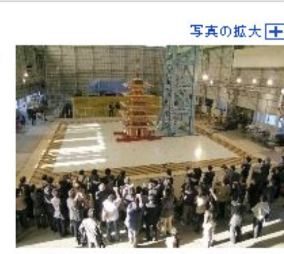
防災科学技術研究所で行われた五重塔の模型の振動実験。揺れのメカニズムの解明を目指す(2004年) = 河合上席研究員提供
